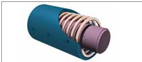
شکل (۷) - ساختار یک مبدل مگنتواستریکتیو ساده
